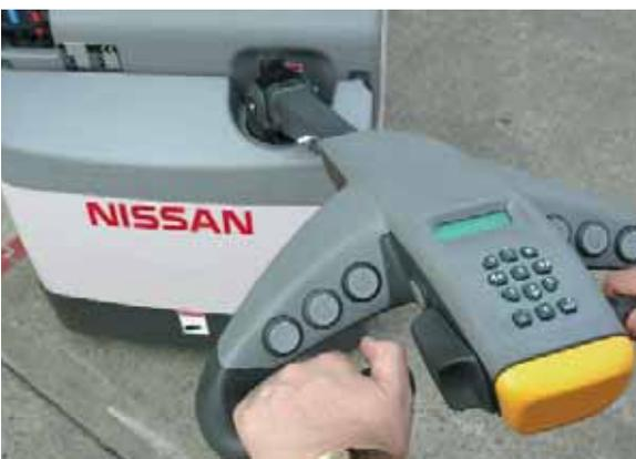
*Maniobras más fáciles y seguras con el timón ergonómico Nissan, que incorpora funciones de elevación y descenso duplicadas, microordenador ATC4 T4 de serie que permite prescindir de la llave de contacto.*
